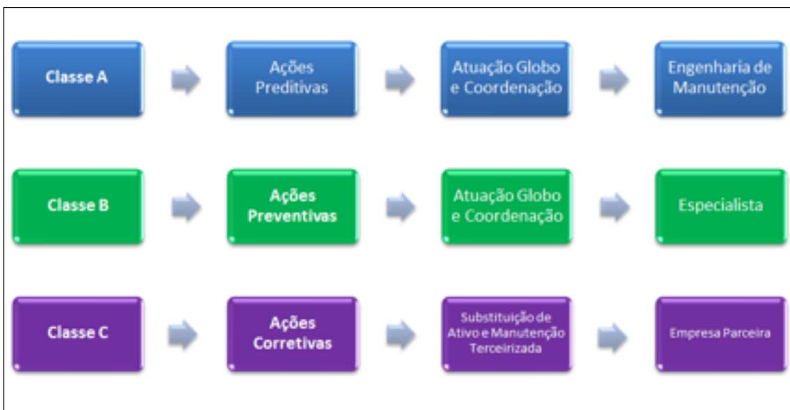
Figura 1 - Definições das Classes - Atuação da Manutenção. Fonte - O Autor.
